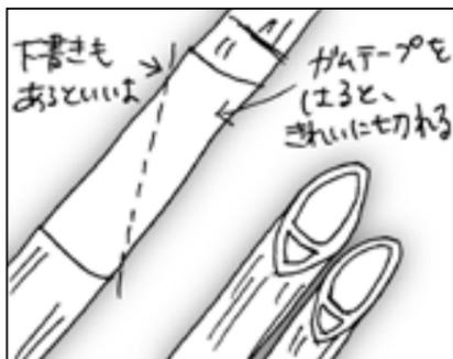
竹の先を尖るように切ります。切り口を長めにすると、見栄えがします。左右3本ずつ、合計6本を用意します。
